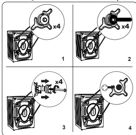
1. Antes de operar a máquina de lavar, remova os 4 parafusos de transporte e os espaçadores de borracha da traseira da máquina. Se os parafusos não forem removidos poderão causar muita vibração, ruído e avaria da máquina e causar a anulação da garantia.
