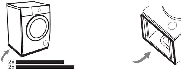
1, Coloque la máquina en el suelo, usando algún material suave como espuma o ropa, entre la máquina y el suelo para una protección;
